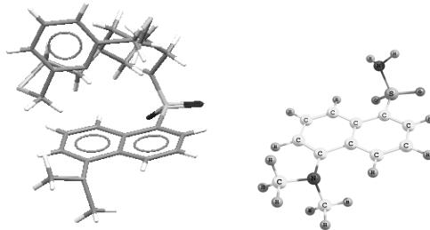
использования в качестве флуоресцентных меток. В настоящей работе выполнено определение геометрического строения свободной молекулы дансил амида (5-(ди-метиламино)нафталин-1-сульфонамид) и сравнение структуры свободной молекулы с молекулярной структурой в кристаллах.
